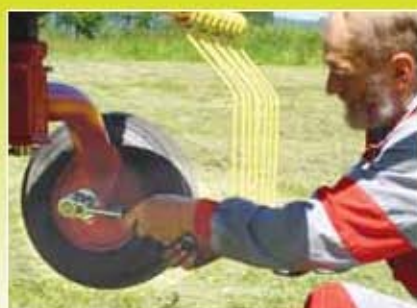
Excentrický čep a zajišťovací matice umožňující seřizování vodorovné polohy stroje
